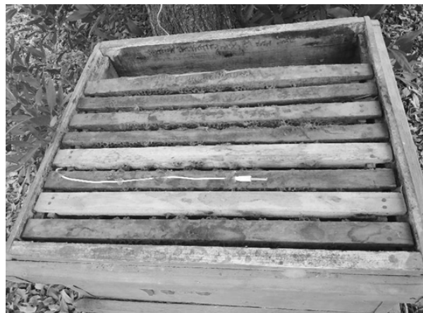
شکل ۲) نمایی از نحوه قرار دادن سنسور دماسنج جهت اندازه گیری دمای داخل کندو
