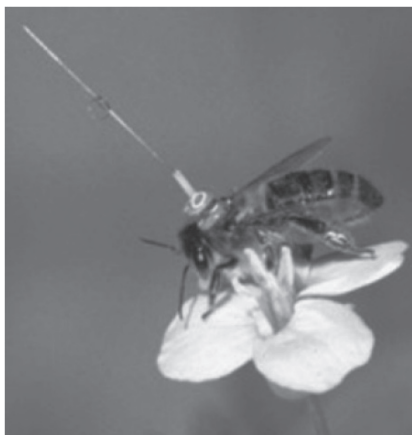
شکل ۳) رادار هارمونیک نصب شده بر روی زنبور عسل همراه با آنتن بلند و عمودی (Bromenshenk et al. , 2015)
